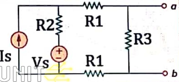
Take:  $R_1=12\Omega$ ,  $R_2=6\Omega$ ,  $R_3=15\Omega$ ,  $V_s=18V$ ,  $I_s=3A$
