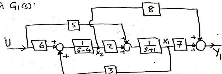
$$\Rightarrow \begin{bmatrix} -3 & s-4 & 0 \\ s+1 & -2 & 0 \\ -7 & -8 & 1 \end{bmatrix} \begin{bmatrix} x_1 \\ x_2 \\ u \end{bmatrix} = \begin{bmatrix} 6 \\ 5 \\ 0 \end{bmatrix} \Rightarrow Ax = b$$
