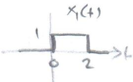
$$(b) \quad x(t) = x_1(t) + x_2(t) \Rightarrow x_1(t) = \text{rect}\left(\frac{t-1}{2}\right)$$
