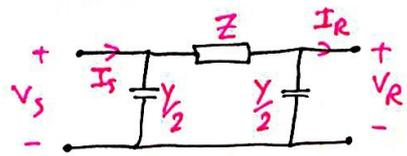
$$\begin{bmatrix} V_s \\ I_s \end{bmatrix} = \begin{bmatrix} 1 + \frac{ZY}{2} & Z \\ Y + \frac{ZY^2}{4} & 1 + \frac{ZY}{2} \end{bmatrix} \begin{bmatrix} V_r \\ I_r \end{bmatrix}$$
