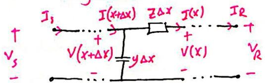
$$\begin{bmatrix} V_s \\ I_s \end{bmatrix} = \begin{bmatrix} \cosh \gamma L & Z_c \sinh \gamma L \\ \frac{1}{Z_c} \sinh \gamma L & \cosh \gamma L \end{bmatrix} \begin{bmatrix} V_r \\ I_r \end{bmatrix}$$
