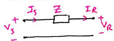
$$\begin{bmatrix} V_s \\ I_s \end{bmatrix} = \begin{bmatrix} 1 & Z \\ 0 & 1 \end{bmatrix} \begin{bmatrix} V_r \\ I_r \end{bmatrix}$$
