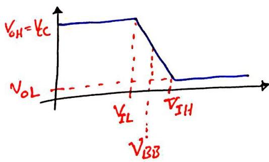
$$V_{OH} = V_{CC} - I_{C,I} R_{C,I} \Rightarrow V_{OH} = V_{CC}$$
