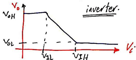
$$V_{IL} = V_{BE(on)} + V_{D(on)} = 0.7 + 0.7 = 1.4 \text{ volt.}$$
