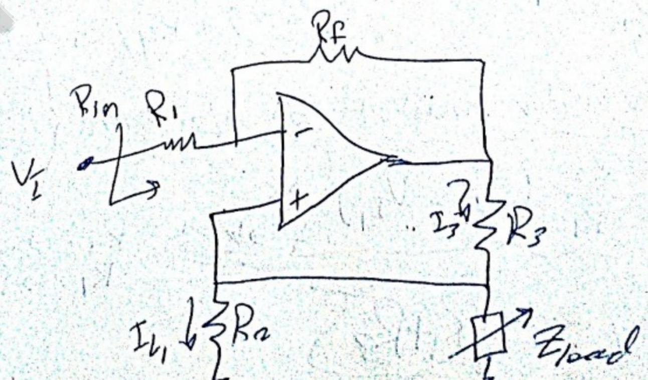
$$\Rightarrow I_L \left( \frac{R_f Z_L}{R_1 R_3} - 1 - \frac{Z_L}{R_2} \right) = V_I \left( \frac{R_f}{R_1 R_3} \right)$$
